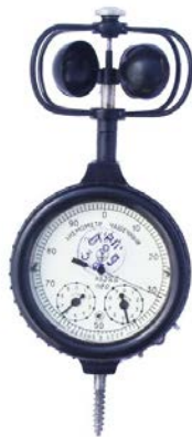
Рис. 3. Чашковий анемометр МС-13
