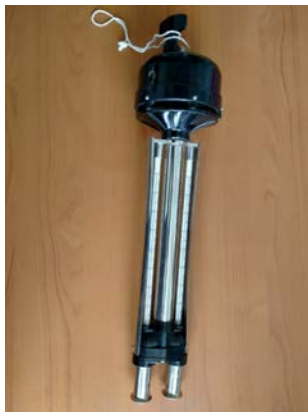
Рис. 2. Аспіраційний психрометр Ассмана МВ-4М
